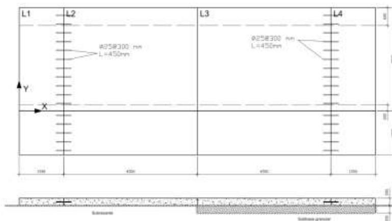
**Figura 2.1** Esquema de distribución y características geométricas del tramo experimental
