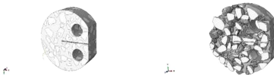
**Figura 5.5.** Probeta virtual de ensayos de concreto de cemento portland y estudio de propagación de grietas con modelación micromecánica
