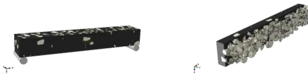
**Figura 5.4.** Probeta virtual para la modelación micro-mecánica del ensayo a flexión de vigas de concreto de cemento portland
