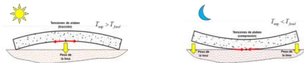
a) Curvatura de la losa de concreto por diferencia de temperatura positiva (diurna)
