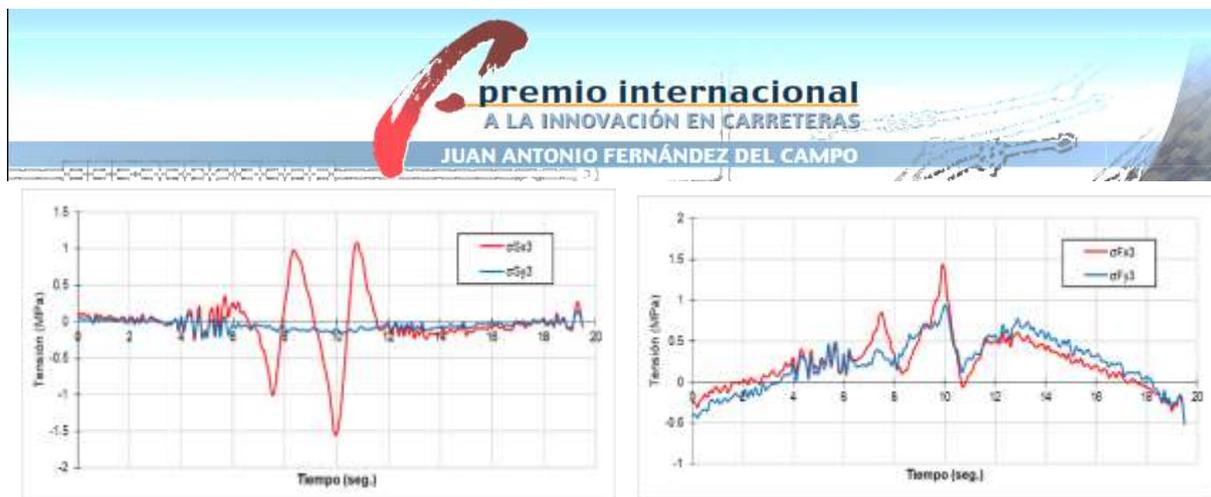
**Figura 2.12.** Tensiones calculadas en la superficie y fondo de la losa durante el día (Caso 1)
