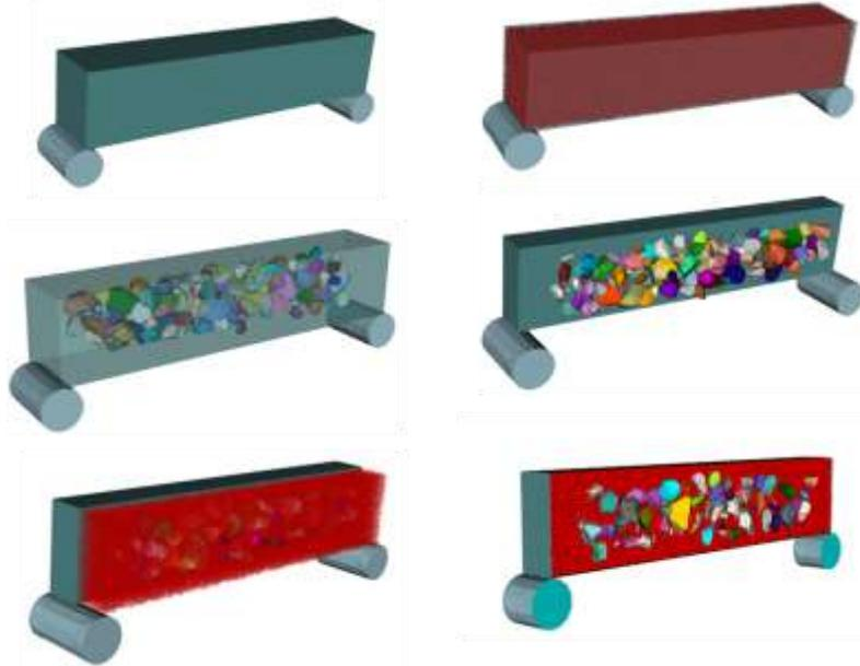
**Figura 5.6.** Probeta virtual del ensayo a flexión de vigas de concreto de cemento portland para modelación micro-mecánica con el método de los elementos discretos.
