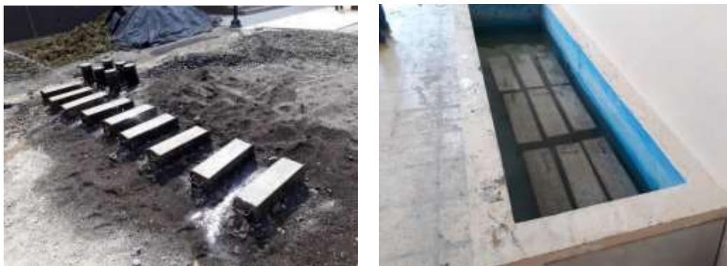
**Figura 2.5** Muestras de concreto de sección prismática para la determinación del módulo de rotura.
