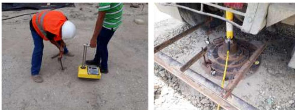
**Figura 2.3 Control de compactación y determinación de la resistencia del cimiento**
